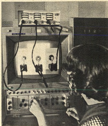
Bild 1. Mit Hilfe fotoelektrischer Sensibilitoren werden aus dem Referenzweiß die Intensitätsanteile der drei Farbauszüge ermittelt
