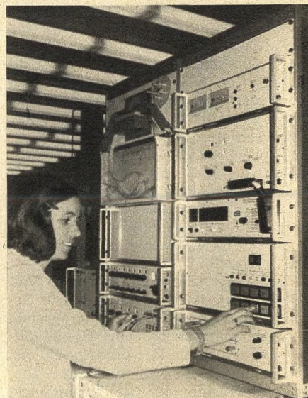
Bild 1. Ausführungsbeispiel eines programmgesteuerten Meßautomaten mittlerer Größe – aufgebaut aus Pegamat-Bausteinen – zum Messen von Pegeln, Dämpfungen, Pegel- und Dämpfungsdifferenzen. In dem Grenzwertvergleich (rechts oben) werden die Meßwerte mit von Hand oder vom Programm her einstellbaren Toleranzen verglichen
